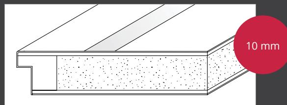
\*INOX umetci na furniranoj površini mogući su samo u smjeru strukture
